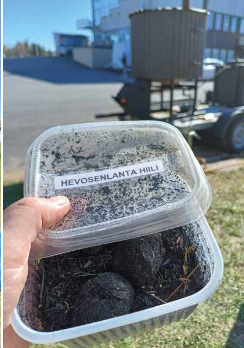
Korkeimmillaan pyrolyysilaitteen lämpötila kävi päivän aikana jopa 700 asteessa ja kutterikuivikepitoisen hevosenlantapanoksen ajo biohiileksi kesti noin kahdeksan tuntia. Eri raaka-ainesta valmistetuissa biohiilissä on eroja. Kuvat Katja Heikkinen.
