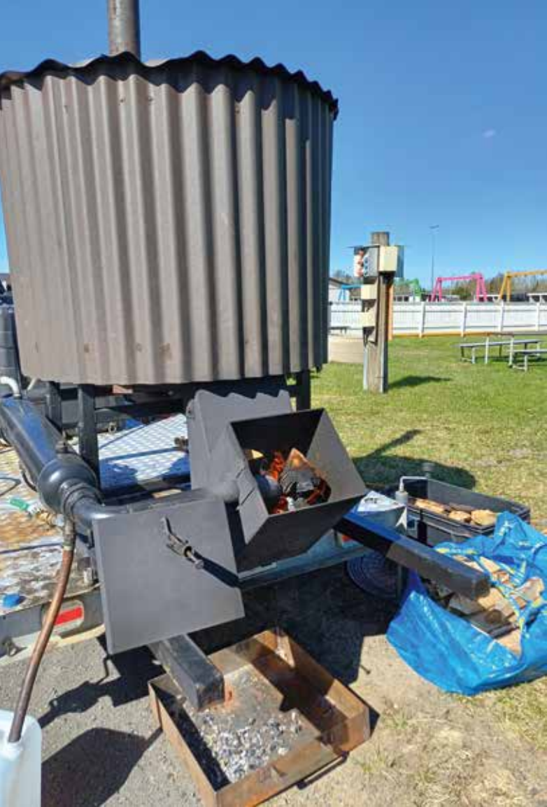
Korkeimmillaan pyrolyysilaitteen lämpötila kävi päivän aikana jopa 700 asteessa ja kutterikuivikepitoisen hevosenlantapanoksen ajo biohiileksi kesti noin kahdeksan tuntia. Eri raaka-ainesta valmistetuissa biohiilissä on eroja. Kuvat Katja Heikkinen.
